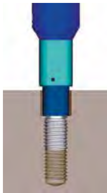
Diametro ridotto per controfori.
