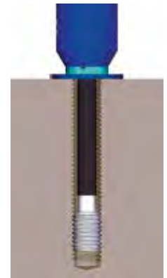
Prolungamento del calibro a tampone per fori molto profondi.
