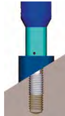
Manicotto d'appoggio angolare per fori inclinati.
